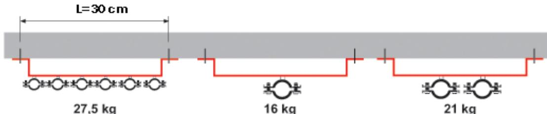
Carichi raccomandati<sup>1)</sup> per staffatura a mensola mediante Sistema QUICK-FIX.
